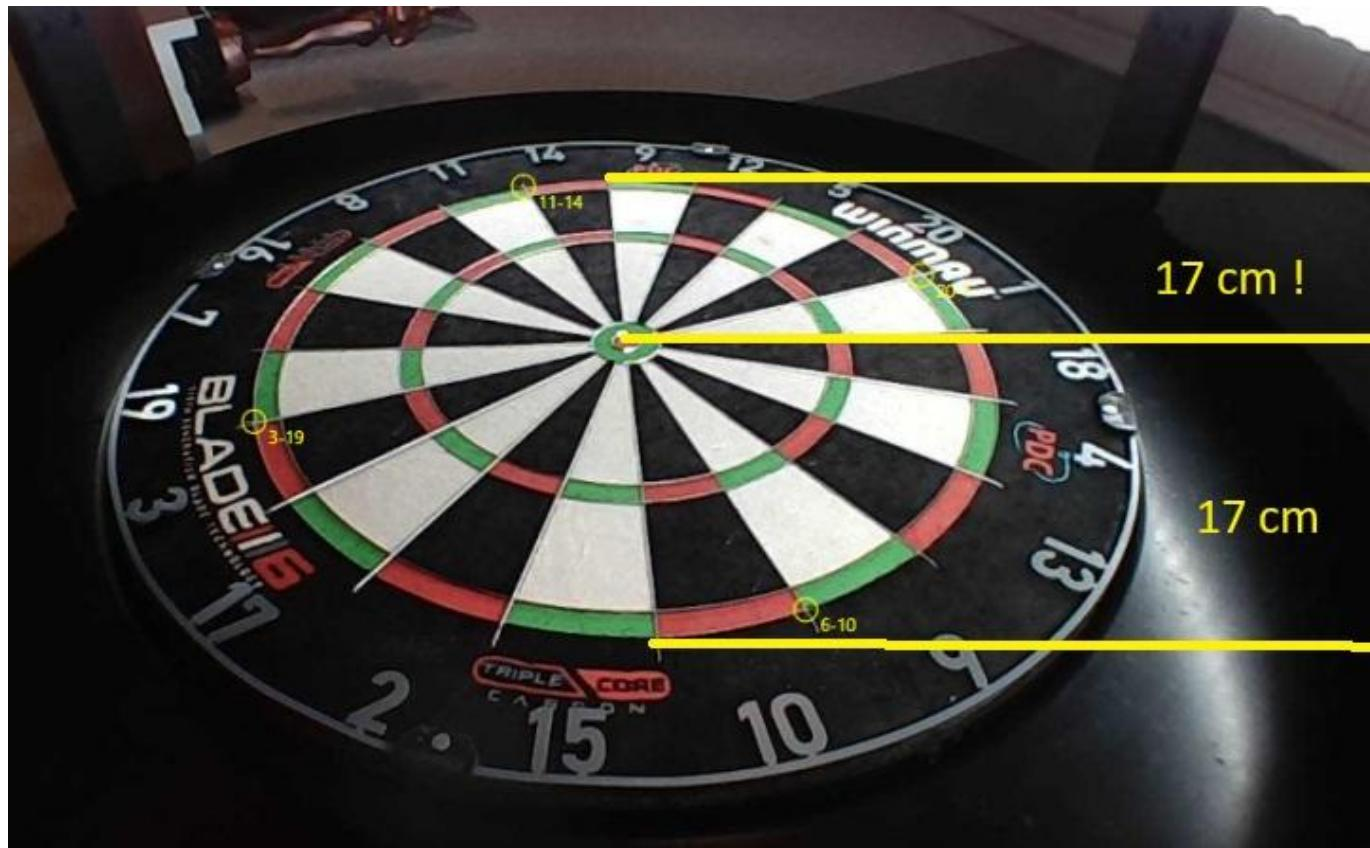
Der Bereich der hinteren Hälften hat hier natürlich , auch wie der vordere, 17cm, aber da für jede Kamera das Bild wieder aufrecht gerechnet wird, werden die Pixelzeilen dann natürlich in der Höhe gestreckt und erscheinen dadurch unschärfer
